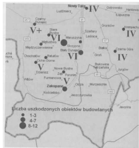
Rys. 5. Liczba uszkodzonych obiektów budowlanych wskutek trzęsienia ziemi 30 listopada 2004 r. oraz szacowane intensywności wstrząsu (skala EMS-98)
